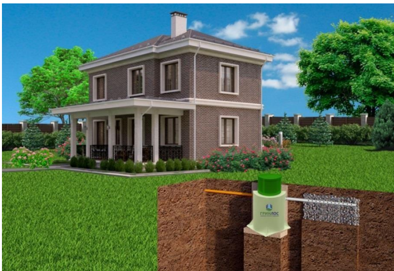
Рисунок 10. Монтаж с отводом очищенных сточных вод в фильтрующий колодец
