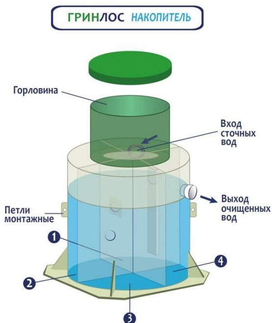
Рисунок 1. Устройство септика ГРИНЛОС Накопитель
